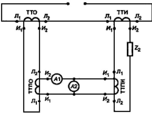
ТТО - образцовый трансформатор тока; ТТИ - испытуемый трансформатор тока; ТТПИ - промежуточный трансформатор тока, находящийся в цепи испытуемого трансформатора тока; ТТПО - промежуточный трансформатор тока, находящийся в цепи образцового трансформатора тока;  $A_1$ ,  $A_2$  - амперметры;
