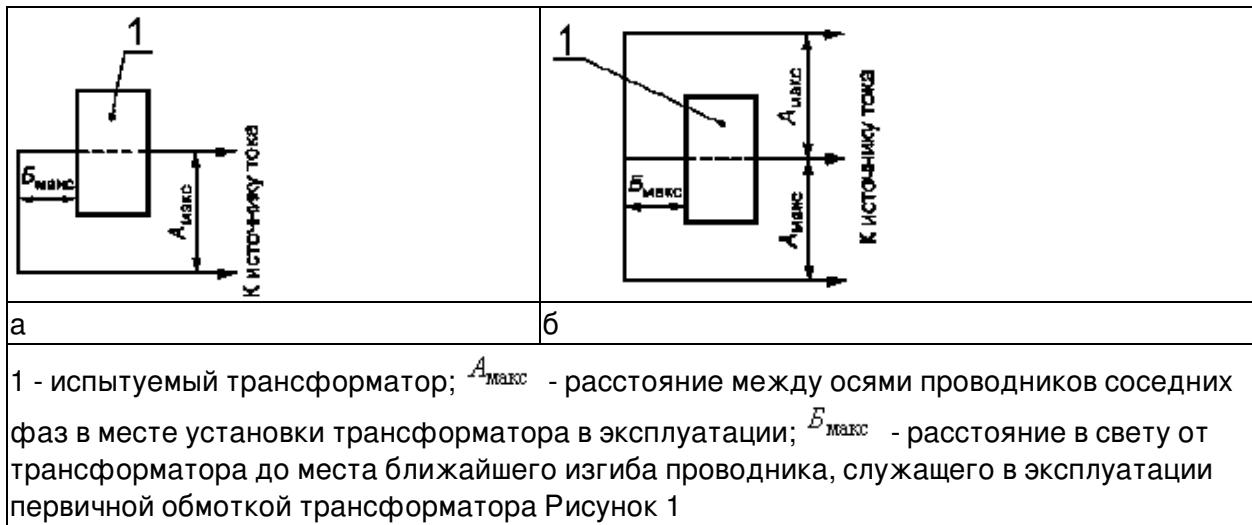
Численные значения размеров  $A_{\max}$  и  $B_{\max}$  должны быть установлены в стандартах на трансформаторы конкретного типа и при испытании они не должны быть превышены.
